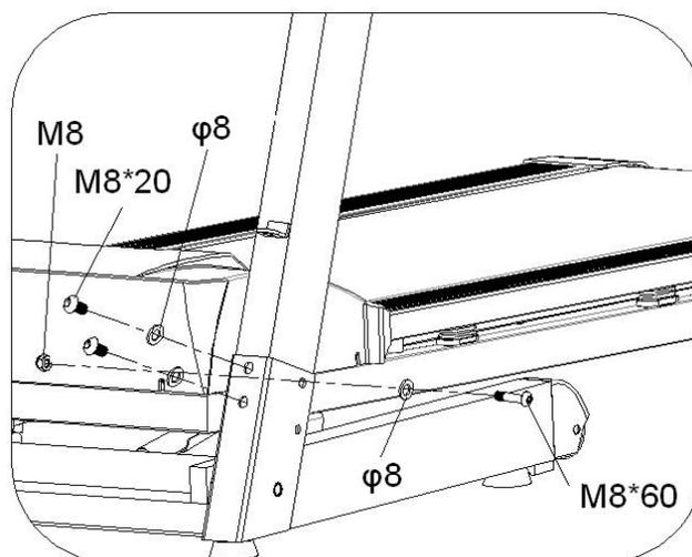
**C)** Použijte klíč č. 5 a připevněte ovládací panel k nosníkům pomocí šroubů M8\*20.
