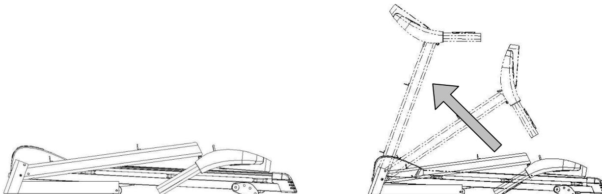
**B)** Použijte klíč č. 5 a připevněte nosníky k základně pásu pomocí šroubů M8\*60 a matic M8. Zajistěte nosníky pomocí šroubů M8\*20.
